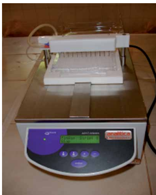
Figura 89 – Lavagem manual ou com o auxílio de um lavador automático de placas, após cada incubação (para remoção do antissoro, do extrato de tecidos vegetais e do antissoro conjugado).
