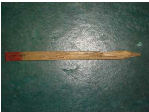
Figura 26: Estaca de Pinus atacada por cupim subterrâneo com atribuição de nota 4.
