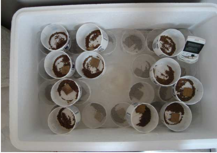
Figura 27 - Potes plásticos contendo papelão corrugado impregnado de extratos vegetais, areia umedecida com água destilada e cupins C. gestroi no interior de caixa de isopor. Medição de temperatura relativa do ar e umidade do ar com aparelho Termohigrometro no Laboratório de Fitossanidade do JBRJ.
