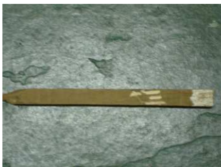
Figura 25: Estaca de Pinus atacada por cupim subterrâneo com atribuição de nota 2.
